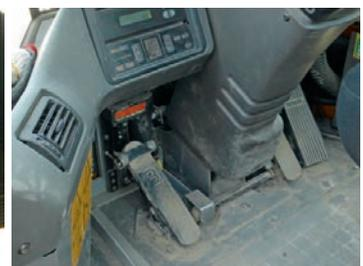
合材プラントで活躍するホイールローダーの後部に設置したステレオカメラ。人などの障害物を検知すると、運転席のモニターで警告(中央の写真)するとともに、後付けした電動シリンダーがブレーキペダルの先端を自動で引き込む(右)
