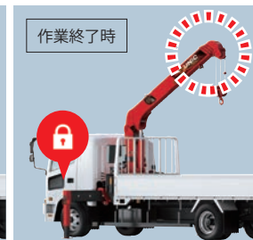
4 ブーム・アウトリガインターロック装置 アウトリガを設置しないとブーム格納解除を規制し、ブームを 格納しないと縦アウトリガの縮小を規制します。
