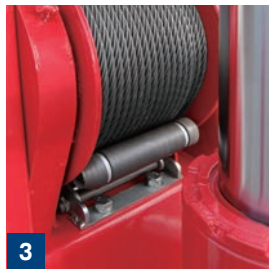
3 ダブルワイヤロープ押え装置 押えローラを強化して、乱巻 きを防止します。
