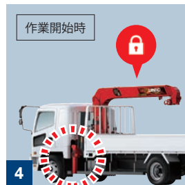
4 ブーム・アウトリガインターロック装置 アウトリガを設置しないとブーム格納解除を規制し、ブームを 格納しないと縦アウトリガの縮小を規制します。
