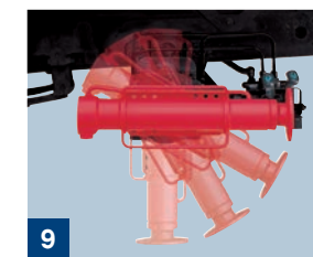
9 回転格納式リヤアウトリガ 作業時の安定性と、走行時 の地上高確保を両立します。
