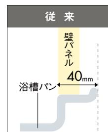
壁パネルの設置スペースが大きい構造。
