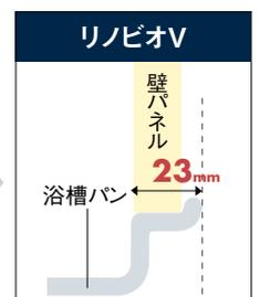
壁パネルの設置スペースを縮小したコンパクトな構造。
