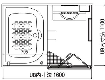
※給水給湯配管がB面壁貫通金具仕様の場合は、システムバスルームの壁裏に給水給湯配管を通す為、UB据付必要寸法が変わります。詳細はP.96をご参照ください。
