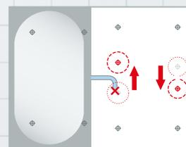
洗い場床下中央付近のボルト脚は、位置の移動が可能で、排水管や給水管の干渉をかわす工夫をしています。
