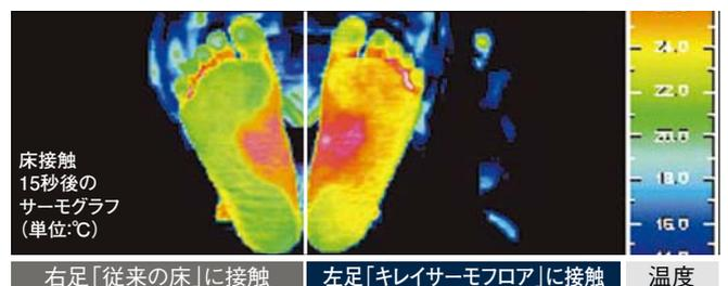
上図は左足をキレイサーモフロアに、右足を従来の床に15秒間接触した後の足裏の温度分布をサーモグラフで示したものです。 ●測定条件 床表面温度:5°C 足裏の初期温度:27°C 被験者:成人
