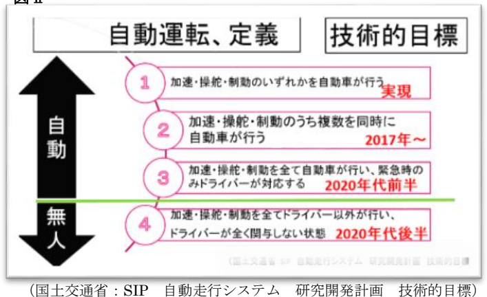
(国土交通省: SIP 自動走行システム 研究開発計画 技術的目標)
